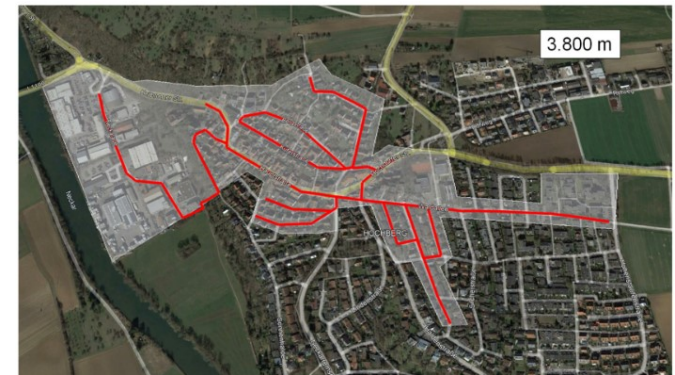
Abb. 80: Mögliche Trassenführung Wärmenetz Hochberg (WP2023)
